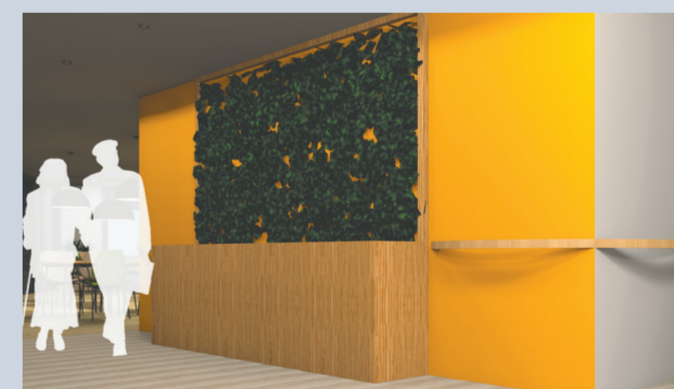
Vegg som med gjenvinningsstasjon i høyde 900 mm, med en plantevegg over seg. Organisk formede støtthåndtak på siden.
