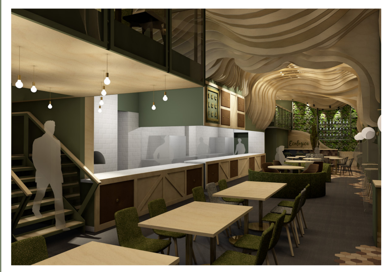
▲ VISUALISERING: Restaurantens konseptbærende element er behandlingen av himlingen, som består av 166 unike "lameller" skåret ut av kryssfinerplater som til sammen danner et biomorfisk formmønster som gir en følelse av at himlingen bølgjer bortover.
