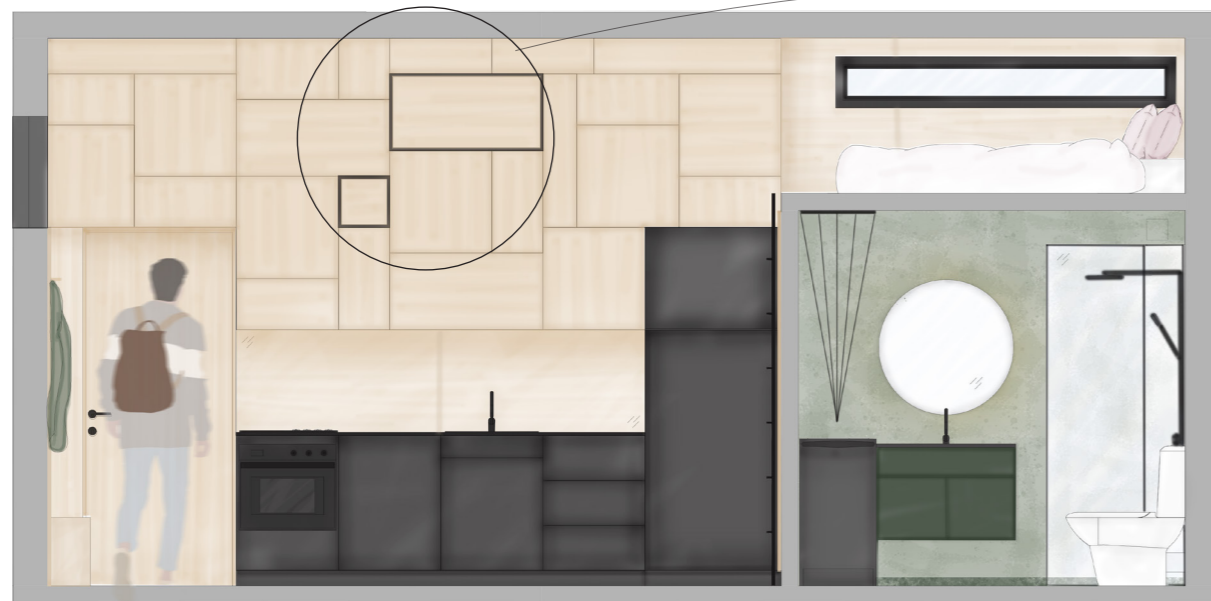
Opprisset viser stålmodulene plassert i overskapene
