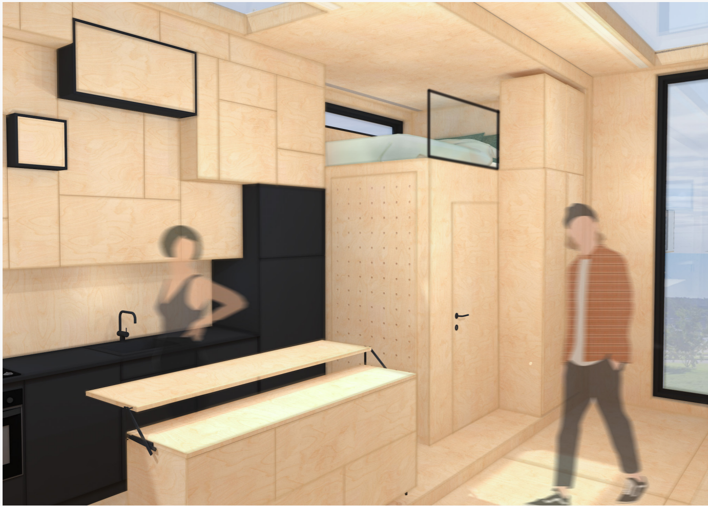
Bordets høyde gir mulighet for en forlengelse av kjøkkenbenken når det er behov for større arbeidsflater
