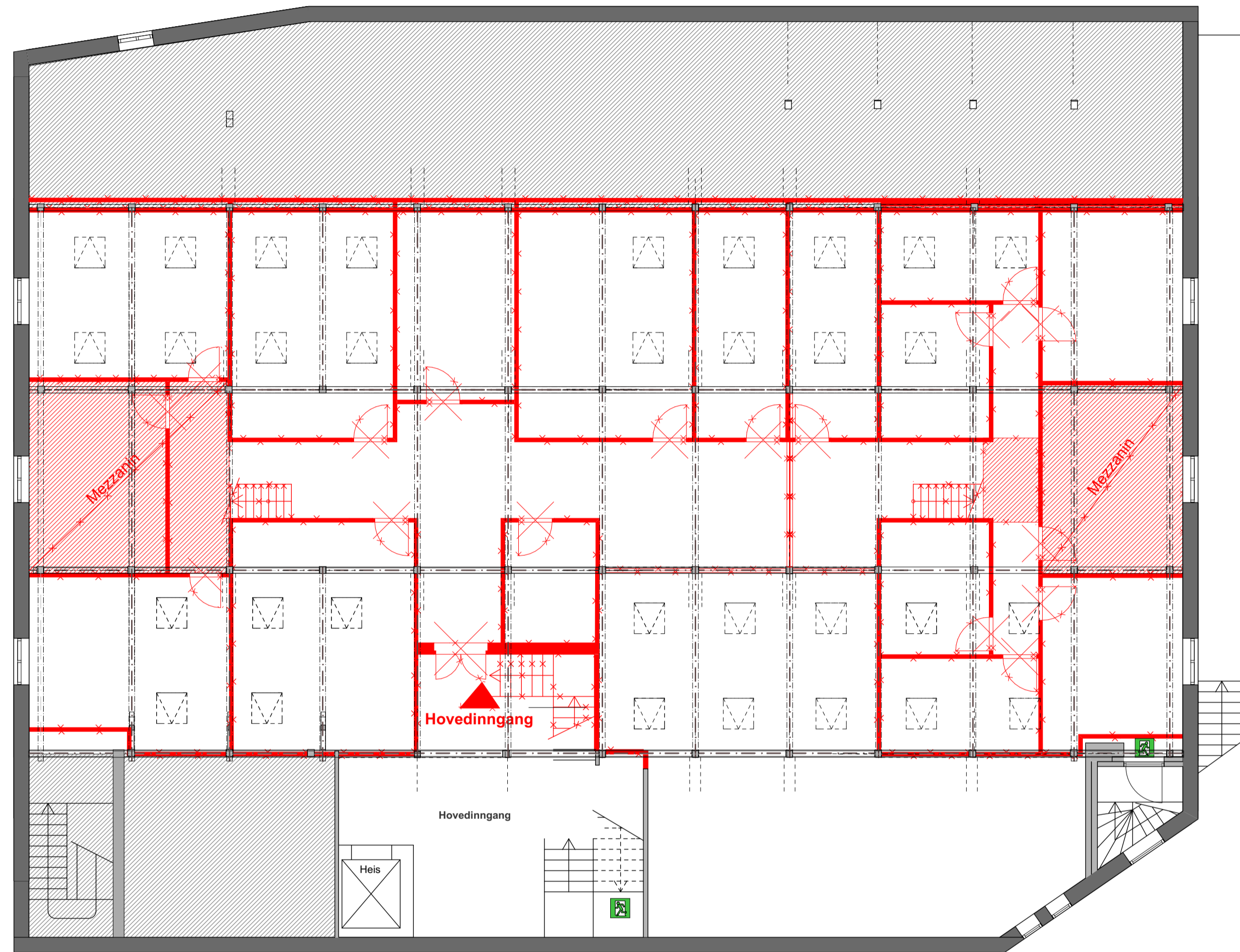
Plan rivning - 4 etg. og mezzanin
