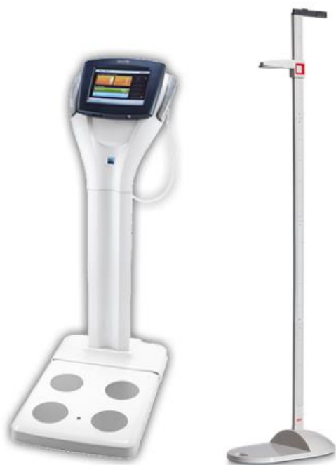
Figur 1: Til venstre viser figuren Tanita kroppsanalysemonitor (Tanita® MC-980MA, Tanita Co., Maeno-cho, Itabashi-ku, Tokyo, Japan) (42). Til høyre viser figuren Seca flyttbar stadiometer for måling av høyde (Seca 213, Seca gmbh &co, Hamburg, Tyskland) (43).
