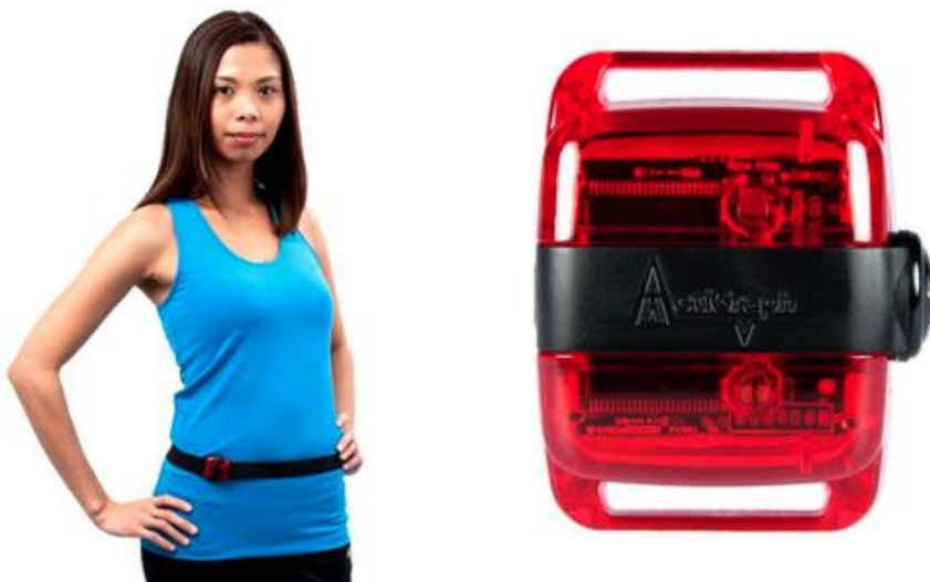
Figur 2: Figuren viser ActiGraph wGT3X-BT akselerometeret (ActiGraph, LLC., Pensacola, FL, USA) (43). Til venstre vises korrekt montering rundt hoftene. Til høyre vises Akselerometeret oven ifra, med åpningsmulighet til mini-USB på høyre side.
